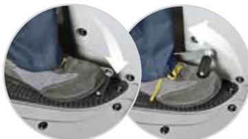
Die Mittel- und Seitenbürsten werden ganz einfach über 2 Hebel abgesenkt und angehoben
