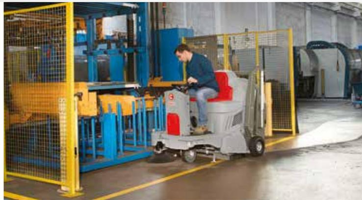
CS700/800 B-H sind Aufsitz-Kehrmaschinen mit automatischem Antrieb. Sie sind mit Batteriespeisung oder mit Benzinmotor erhältlich und besitzen eine Arbeitsbreite von 70 bzw. 80 cm (Mittelbürste). Das größere Modell der Produktreihe erreicht mit den beiden Seitenbürsten eine Arbeitsbreite von 112 cm.
