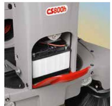
Bei den Ausführungen mit Motorantrieb (CS700-800 H) befindet sich die Starterbatterie im vorderen Fach und kann bequem kontrolliert werden
