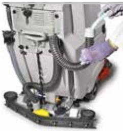
Damit das Trocknen immer perfekt erfolgt, müssen zum Ende jedes Einsatzes der Saugschlauch und die Gummis am Saugfuß gereinigt werden. Letzterer kann angehoben werden, so dass man leicht an die Gummis gelangt und diese schnell reinigen kann
