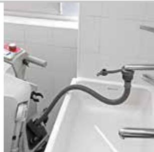
Der Schlauch zum Befüllen des Reinigungsmittel tanks lässt sich direkt an jeden Hahn anschließen, wodurch der Vorgang überall rasch durchgeführt werden kann
