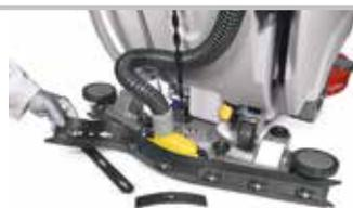
Die Gummis des Saugfußes können in wenigen Augenblicken gedreht und gewechselt werden, ohne Einsatz von Werkzeugen
