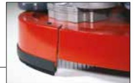
Nivellierender Spritzschutz, für eine noch bessere Reinigungsleistung (Versa 55 und 65)
